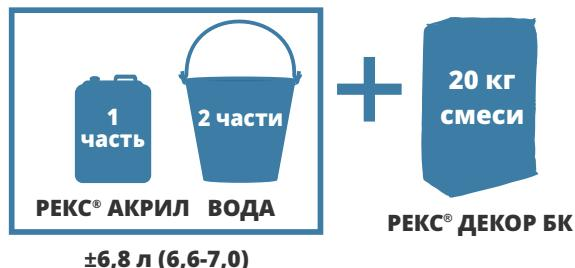
**Важно!!!** При контакте с более агрессивной средой (плавательные бассейны, резервуары для воды и др.) рекомендуется увеличивать в жидкости для смешивания пропорцию РЕКС® АКРИЛ.
