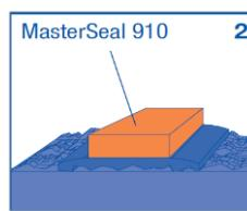
После установки MasterSeal 910 зона шва должна содержаться чистой, без свободных частиц и грязи до бетонирования.
