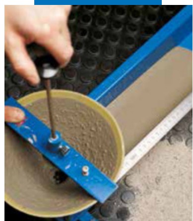
Испытание расширения в канавке согласно итальянской норме UNI 8997/89
