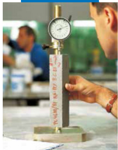
Определение расширения в стесненных условиях согласно итальянской норме UNI 8997/89
