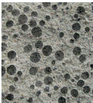
Структура затвердевшего раствора, изготовленного из «Рунит Аэродекор»
