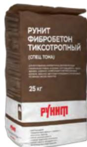
Для изготовления архитектурных деталей методом набивки. На основе портландцемента, песка, добавок. Содержит армирующие полипропиленовые волокна. М300, F400. Выпускается под заказ с колеровкой по образцу.
