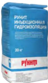
Для устранения протечек воды через тело бетонных и кирпичных конструкций, трещины и конструкционные швы методом инъектирования. Тонкодисперсный (0,1мм) литевой состав на основе портландцемента. Пк4, М100.
