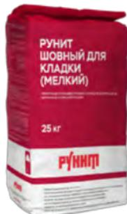
Для восстановления разрушенного шовного раствора облицовки из керамического и силикатного кирпича, натурального камня. На основе извести, карбонатного наполнителя, песка (0,63мм). Содержит гидравлическую добавку. Для заполнения швов глубиной 5-30 мм. Обладает повышенной пластичностью. Возможно нанесение методом экструзии с помощью строительного пистолета-шприца или специального мешка. Оптимален для тонкослойной затирки швов. Возможен подбор по образцу.
