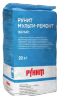
Сухая шпаклевочная смесь. Для выравнивания и восполнения утрат бетона и камня (глубиной 1-5мм). Допускается шлифование и полировка. На основе минерального вяжущего, содержит тонкодисперсный заполнитель (0,1 мм). Быстротвердеющий, безусадочный, тиксотропный с высокой адгезией к основанию. Пк2, М150, F100.
