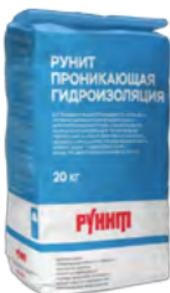
Для повышения водонепроницаемости (не менее 2-х ступеней) сборных и монолитных бетонных и железобетонных конструкций, а также в качестве инъекционного раствора для горизонтальной гидроотсечки. На основе минерального вяжущего, кварцевого песка (0,63мм), специальных химических добавок. Общая толщина слоев 2-3 мм.
