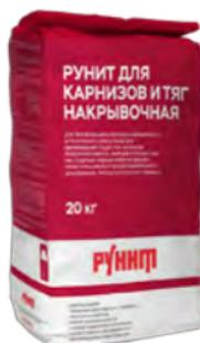
Для протягивания шаблоном накрывочного штукатурного слоя, а также для выравнивания глади стен. На основе воздушной извести, кварцевого песка (0,63 мм). Содержит гидравлическую добавку. Может окрашиваться без дополнительного шпаклевания. Минимальная толщина слоя 3 мм.
