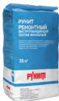
Для срочного ремонта дефектов глубиной 3-10 мм бетонных, железобетонных и каменных конструкций. Безусадочный, тиксотропный. Допускается применение в условиях низких температур. Пк2, М250, F150.
