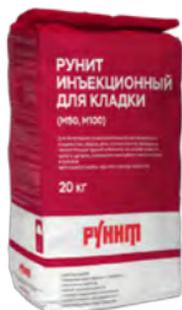
Для укрепления слабой кирпичной и белокаменной кладки стен, сводов, арок, колонн при реставрации и реконструкции зданий и ремонте. На основе извести, белого цемента, карбонатного наполнителя (размер зерна - менее 0,2 мм) и добавок. Выпускается двух разновидностей: нормальной прочности (соответствует марке М50) и повышенной прочности (соответствует марке М100).
