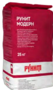
Для грубого выравнивания стен и потолков при реставрации и реконструкции зданий и сооружений. На основе воздушной извести, карбонатного наполнителя, песка (2,5 мм). Содержит добавку портландцемента для ускорения твердения.
