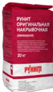
Для накрывочного штукатурного слоя. На основе воздушной извести, минерального наполнителя, кварцевого песка (0,63 мм). Содержит гидравлическую добавку. Может окрашиваться без шпаклевания. Минимальная толщина слоя 5 мм.
