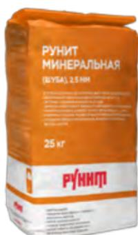
Для тонкослойной штукатурной фактурной (шероховатой) декоративной отделки фасадов и интерьеров, в т.ч. в системах утепления фасадов. На основе цементно-известкового вяжущего, кварцевого наполнителя, мраморной крошки, добавок. Размер зерна крошки 2,5 мм. Возможно создание рельефной фактуры механизированным способом (метод разбрызгивания). Возможна колеровка.
