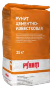
Для грубого выравнивания бетонных и кирпичных оснований при реконструкции, новом строительстве и ремонте. Может затираться под окраску. На основе портландцемента, воздушной извести, карбонатного наполнителя, песка (1,25/0,63 мм), добавок.
