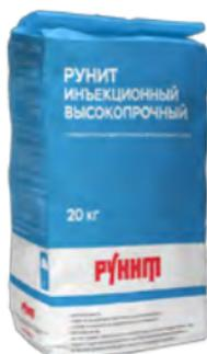
Для ремонта и усиления бетонных и каменных конструкций, скальных пород методом инъектирования. На основе портландцемента и тонкодисперсного наполнителя (0,1 мм). Пк4, В40, F400.
