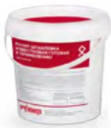
Для финишного слоя под роспись или окраску. Обеспечивает гладкую поверхность «в ноль». Может применяться для создания обмазочного слоя по кладке при реставрации и реконструкции памятников архитектуры. Пастообразная шпаклевка на основе воздушной извести, карбонатного наполнителя (0,1 мм), диспергирующих добавок. Для внутренних и наружных работ.
