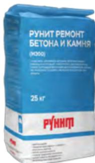
Тиксотропная безусадочная смесь для ремонта бетонных, железобетонных и каменных конструкций. Для заполнения крупных дефектов. На основе портландцемента и кварцевого заполнителя (2,5 мм). Содержит полимерную фибру. Пк2; М300 (М500); F200(F300); W8(W10).
