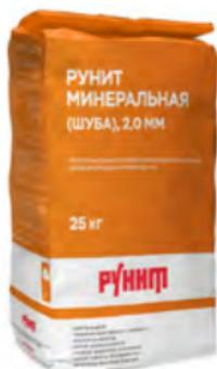
Для тонкослойной штукатурной фактурной (шероховатой) декоративной отделки фасадов и интерьеров, в т.ч. в системах утепления фасадов. На основе цементно-известкового вяжущего, кварцевого наполнителя, мраморной крошки, добавок. Размер зерна крошки 2,0 мм. Возможно создание рельефной фактуры механизированным способом (метод разбрызгивания). Возможна колеровка.
