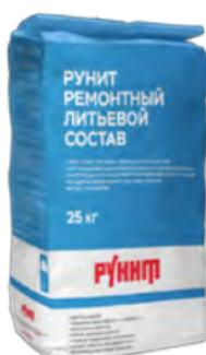
Литьевая безусадочная смесь для ремонта бетонных и железобетонных конструкций, а также для изготовления новых конструкций методом бетонирования. На основе портландцемента и кварцевого заполнителя (2,5 мм). Содержит полимерную фибру. Пк4, М800, F300, W16.
