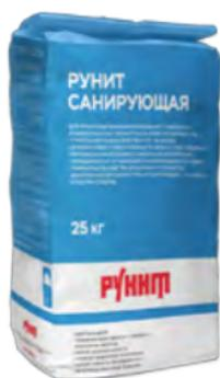
Для грубого выравнивания оснований с умеренной влажностью и засоленностью, а также для обрызга под штукатурку «Рунит Санирующую облегченную». На основе цементно-известкового вяжущего, песка (2,5 мм). Содержит функциональные добавки, снижающие капиллярную проводимость и улучшающие паропроницаемость. Может применяться в качестве штукатурного грунта под декоративную штукатурку «Рунит Терразитовая».
