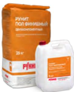
Сухая смесь для создания финишного покрытия по бетону. Пк4, М250. Поставляется в комплекте с жидкостью затворения. Три типовых состава. Возможна колеровка по образцу. Толщина покрытия 5-7 мм. Расход: 1,6 кг/м<sup>2</sup>/1 мм толщины
