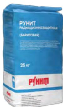
Для изоляции стен и потолков рентгеновских кабинетов и других помещений, в которых ведутся работы с источниками излучений. Толщина одновременно наносимого слоя 5-7 мм. Эквивалентная толщина штукатурки определяется проектным заданием.
