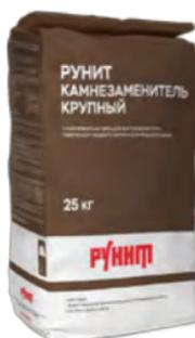
Для восполнения утрат поверхности лицевого кирпича и природного камня при реставрации и реконструкции зданий и сооружений (объемом до 0,5 дм<sup>3</sup>). На основе минерального вяжущего, карбонатного наполнителя, песка (2,5 мм) и добавок. Толщина одного слоя до 10 мм.
