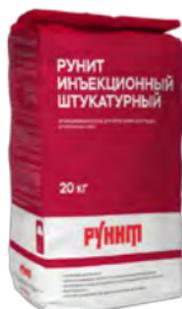
Для укрепления зон «бухчения» известково-цементных штукатурок, в том числе терразитовых и каменных штукатурок при проведении реставрации и реконструкции зданий и сооружений. На основе извести, портландцемента, карбонатного наполнителя (5 мкм) и добавок. Прочность не более 10 МПа.
