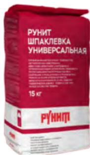
Для выравнивания под окраску поверхностей, оштукатуренных известковыми, известково-цементными, санирующими и теплоизоляционными штукатурками. Применяется при реставрации и реконструкции зданий и сооружений, а также для нового строительства и ремонта. Обеспечивает гладкую поверхность под окраску. На основе воздушной извести, карбонатного наполнителя (0,1 мм). Содержит гидравлическую добавку.
