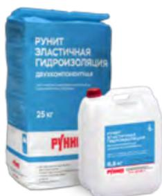
Двухкомпонентный состав (сухая смесь + полимер) для устройства тонкослойной (3-4 мм) гидроизоляции на деформируемых основаниях. Поставляется в комплекте с жидкостью затворения. Пк4, F300, W12.
