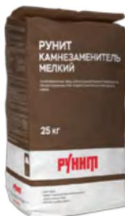
Для восполнения мелких утрат поверхности лицевого кирпича и природного камня (глубиной до 10 мм) при реставрации и реконструкции зданий и сооружений. На основе минерального вяжущего, карбонатного наполнителя, песка (0,63 мм) и добавок. Толщина одного слоя до 5 мм.
