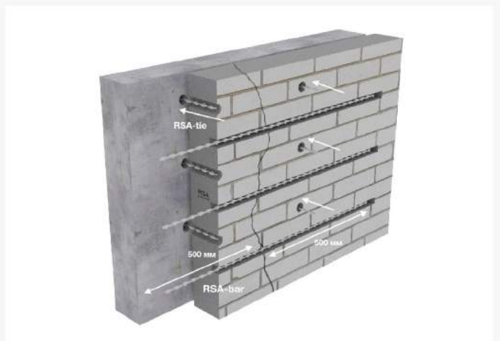
Рис. 18 Ремонт облицовочной кладки
