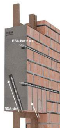
Рис. 12 Ремонт надоконной перемычки вер. 2
