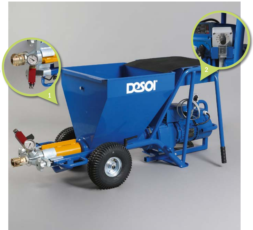
1. Druckschalter mit Manometer | Manometric switch with manometer
