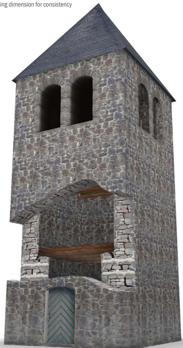
Verbindung abgelöster Mauerwerkschalen Connection of separated wythes
