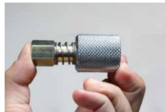
Sicherung gegen die Druckfeder zurückdrücken Press the safety device back against the pressure spring
