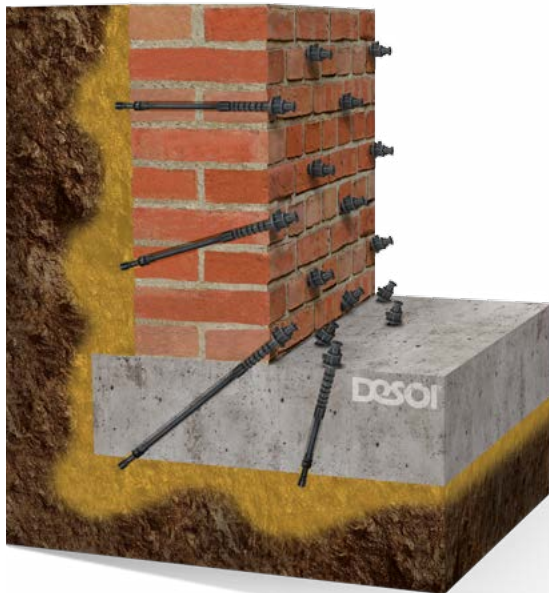
Schleierinjektion | Curtain injection
