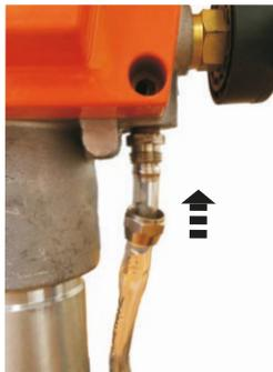
**7.** Поместите заборный патрубок с фильтром в емкость с жидкостью. Рекомендуется при первом включении использовать воду. После проверки работоспособности с водой, переходить к работе с краской.
