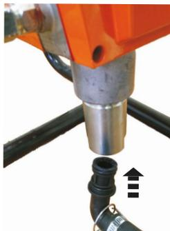
**6.** Наденьте зажим на дренажную трубку. Затем наденьте трубку на штуцер и зафиксируйте зажимом.
